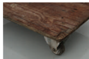
Madera: Astillas y podredumbre.
