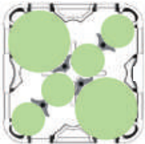
2 Columnas: Diámetro 24.4 a 29.8 cm (60 cada una) 4 Columnas: Diámetro 16.5 a 18.7 cm (45 cada una) Capacidad total: 300
